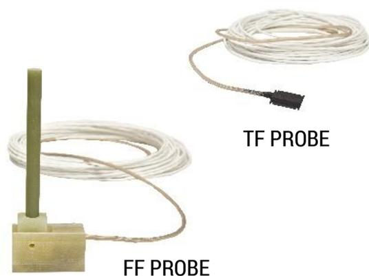
Iris Power Ffprobe<sup>o</sup> и Iris Power FFProbe<sup>o</sup> измеряют скорость изменения потока воздушного зазора для обнаружения укороченных витков обмотки ротора в синхронных двигателях, гидрогенераторах и турбогенераторах.
