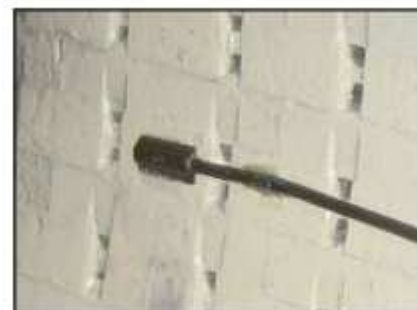
Датчик плотности магнитного потока TFProbe Iris Power, приклеенный к зубьям статора турбогенератора
