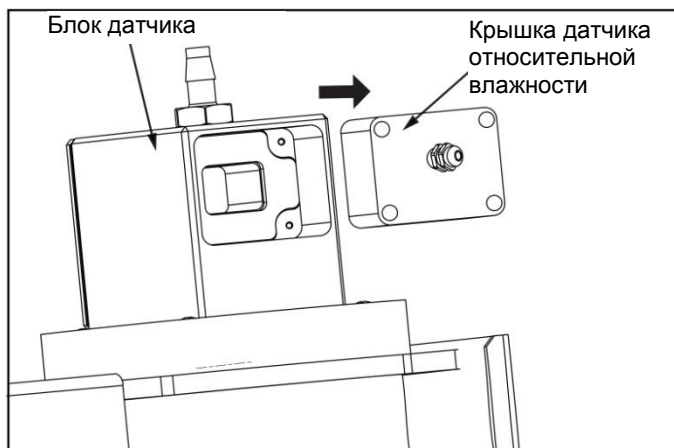
Рисунок 11. Удаление крышки датчика относительной влажности
