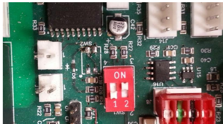
Рисунок 9. DIP-переключатель печатной платы
