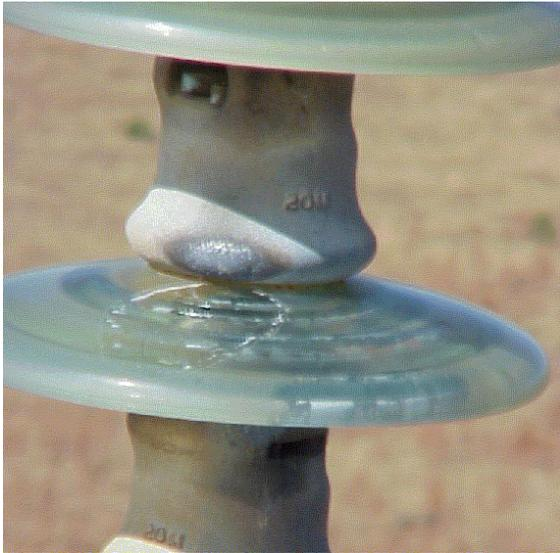
Если за год на одной опоре случились 4 повреждения с успешным АПВ – имеет смысл визуально осмотреть данную опору для предотвращения грядущего повреждения без успешного АПВ.
