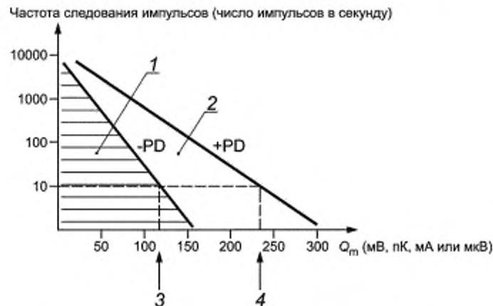
1 — частота следования импульсов отрицательной полярности (-PD) с пиковым значением меньше заданного; 2 — частота следования импульсов положительной полярности (+PD) с пиковым значением меньше заданного; 3 — значение  $Q_m$  для импульсов отрицательной полярности для частоты следования 10 импульсов в секунду; 4 — значение  $Q_m$  для импульсов положительной полярности для частоты следования 10 импульсов в секунду
